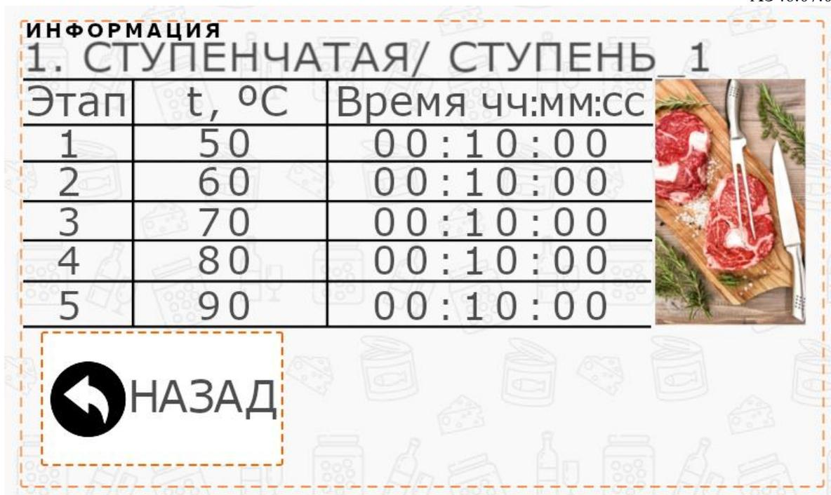
Рис. 23. Информационное окно режимов приготовления продукта в режиме «СТУПЕНЧАТАЯ».
